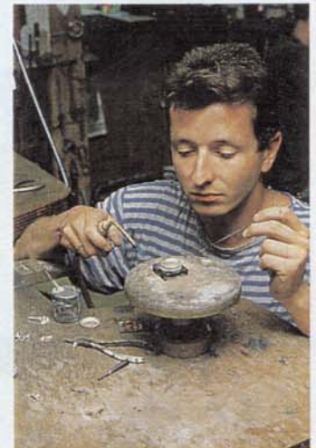
Michael Strunz lötet den Boden und den Rand für eine Jagdkrawatte zusammen
